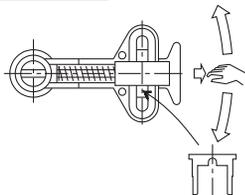
Varnostna sklopka z vilicami, ki se ob preobremenitvi pogona zlomijo, preprečuje okvaro elektromotornega pogona.
