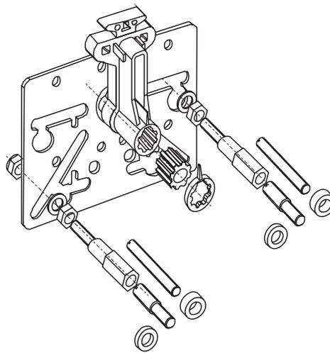
Priloženi komplet adapterjev za prigradnjo motorja na ventile :
